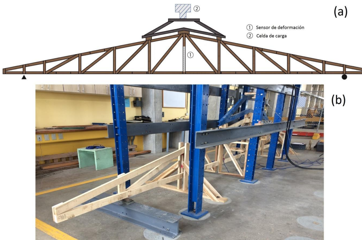
Figura 2. Sistema de aplicación de carga en los ensayos de las cerchas (a), elementos de restricción utilizados para evitar el pandeo lateral de las cerchas durante los ensayos (b).
