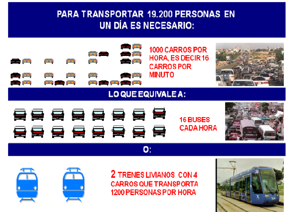
Figura 2: Equivalencias entre diferentes medios de transporte por número de unidades y pasajeros transportados. Fuente: PRUGAM
