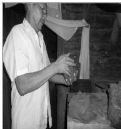
Fig.14. Artesano Teódulo Potosme en el proceso de amasado o tratamiento de la materia prima del barro. Fuente: El Autor.
