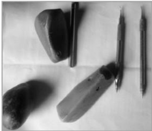
Fig.22. Herramientas básicas utilizadas en el proceso de elaboración de piezas cerámicas; en este caso se aprecian lujadores de madera y plástico además, de algunos instrumentos odontológicos. Fuente: El Autor.
