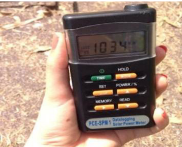
Imagen 4. Medición de la radiación solar con el solarímetro
