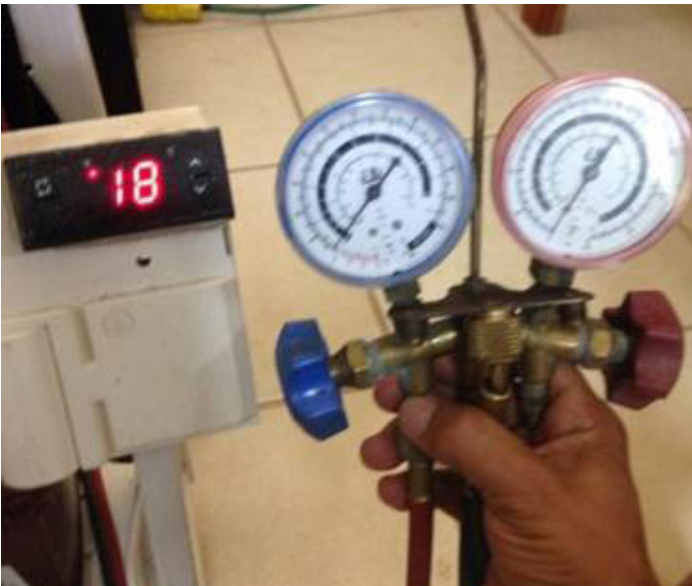
Imagen 3. Manómetro para medir la presión
