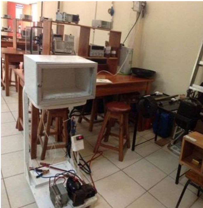
Imagen 1. Refrigerador solar conectado al panel solar
