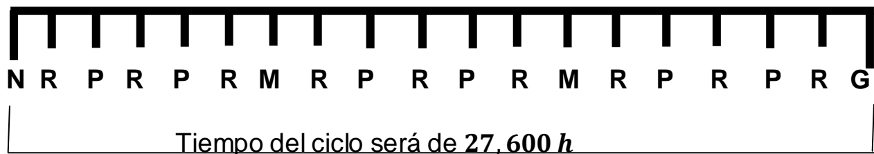
Figura No. 12: Ciclo de mantenimiento para fresadora
