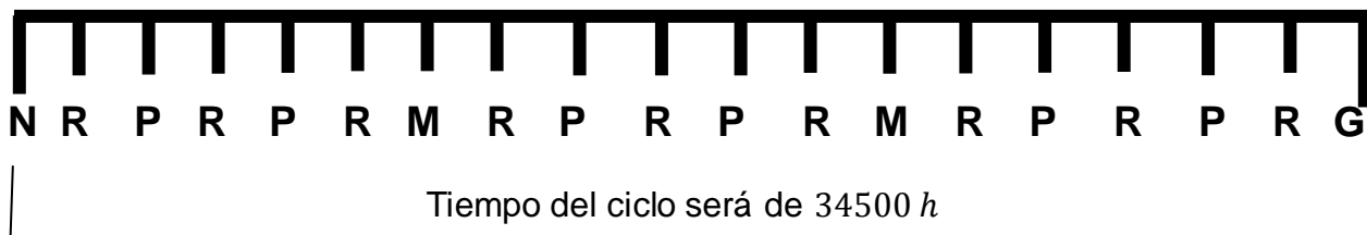
Figura No. 11: Ciclo de mantenimiento para torno
