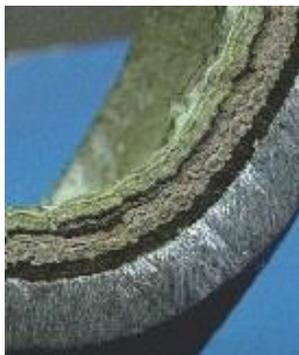
**Depósitos estratificados de diferentes compuestos**
