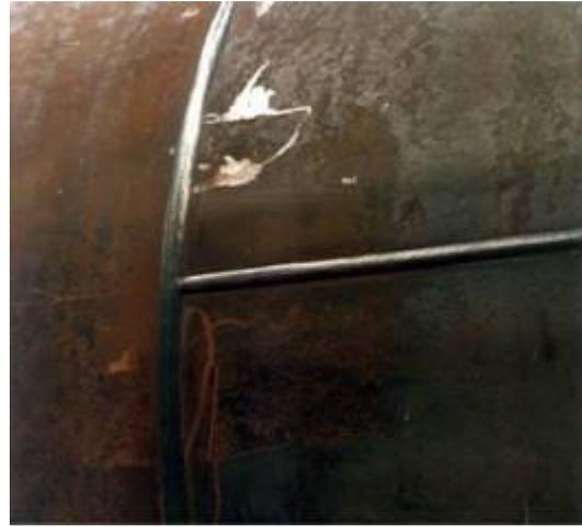
**Corrosión en el interior de las calderas por oxígeno y en el exterior de las calderas**
