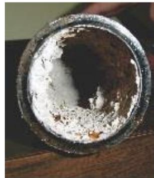
**Depósitos de un solo compuesto**
