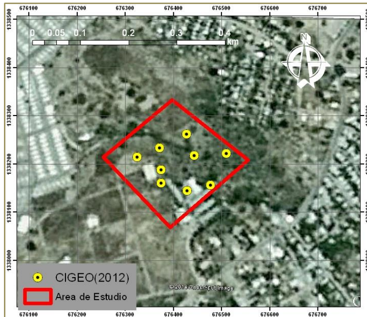
Figura 3.6. Perforaciones realizadas para estudio geotécnico, utilizando el método de SPT, en FAREM-CHONTALES.
