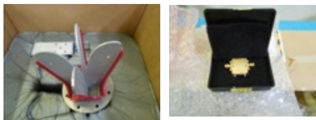
図2 4 K冷凍機の無負荷冷却試験とフロントエンドのアンプとホーン
