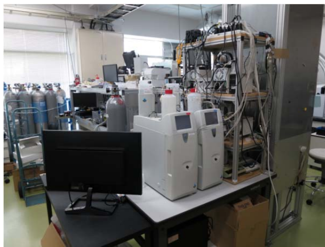
図3 極地研の連続自動分析装置へのイオンクロマトグラフ分析器の接続
