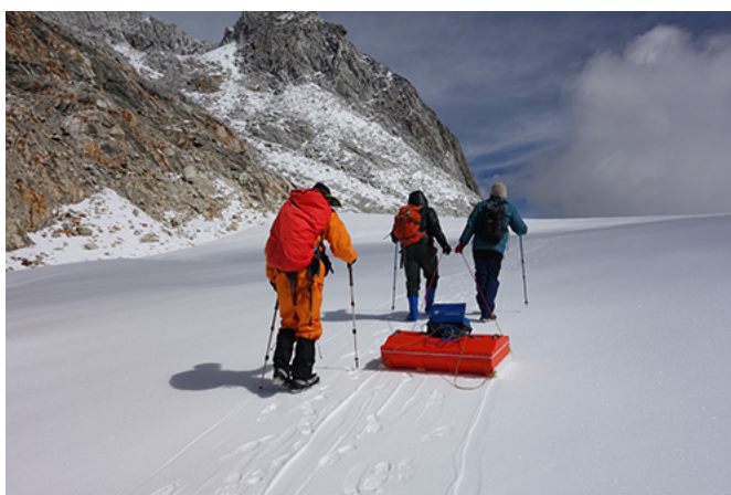
図 1 ガンジュラ氷河上流部での GPR 探査. アンテナの周波数は 100MHz. 2014 年 10 月 12 日撮影.
