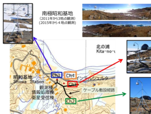
図 1. 南極昭和基地に設置した測定器の位置とその様子。2011年に設置した3測定器はCh1-3、2015年に設置された測定器はCh4。
