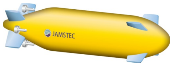
図2 “SuSE”のイメージ図。実際にはX翼がもう少し大きくなる。
