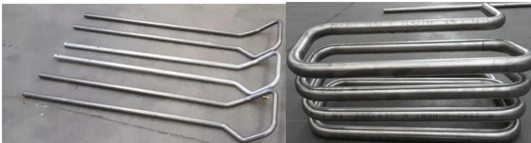
Figura 12 Handles para trolleys (esquerda) tubo para refrigeração de autocarros (direita)
