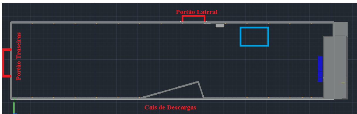
Figura 75 Localização da zona de armazenamento de componentes para a linha de montagem
