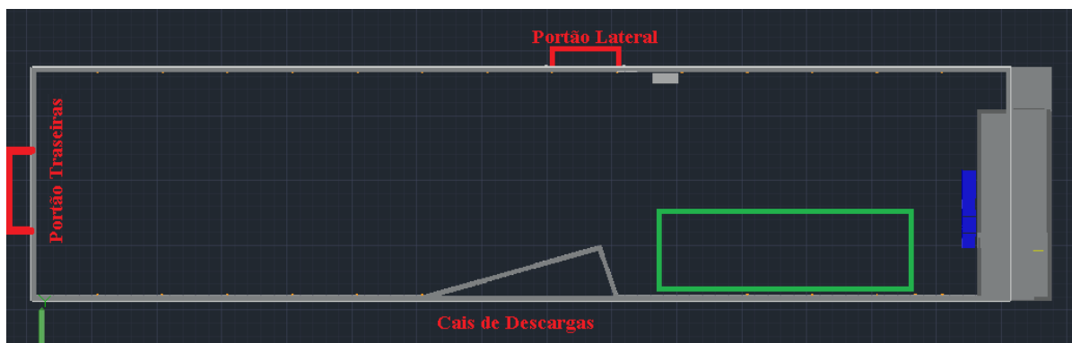
Figura 84 Localização da zona de armazenamento de matéria-prima no pavilhão novo
