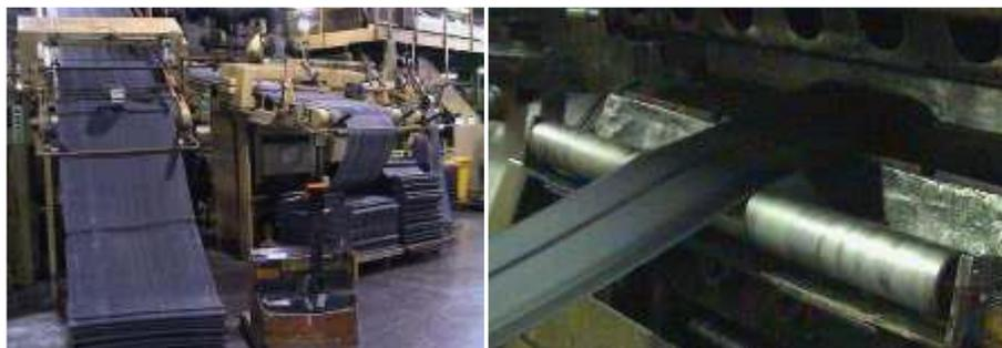
Figura 3.10 – Extrusoras de pisos e paredes.
