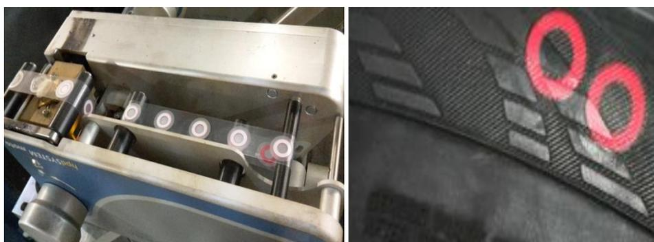
**Figura 4.19 – Rolo de impressão a quente (à esquerda) e respetiva marca (à direita). (24)**
