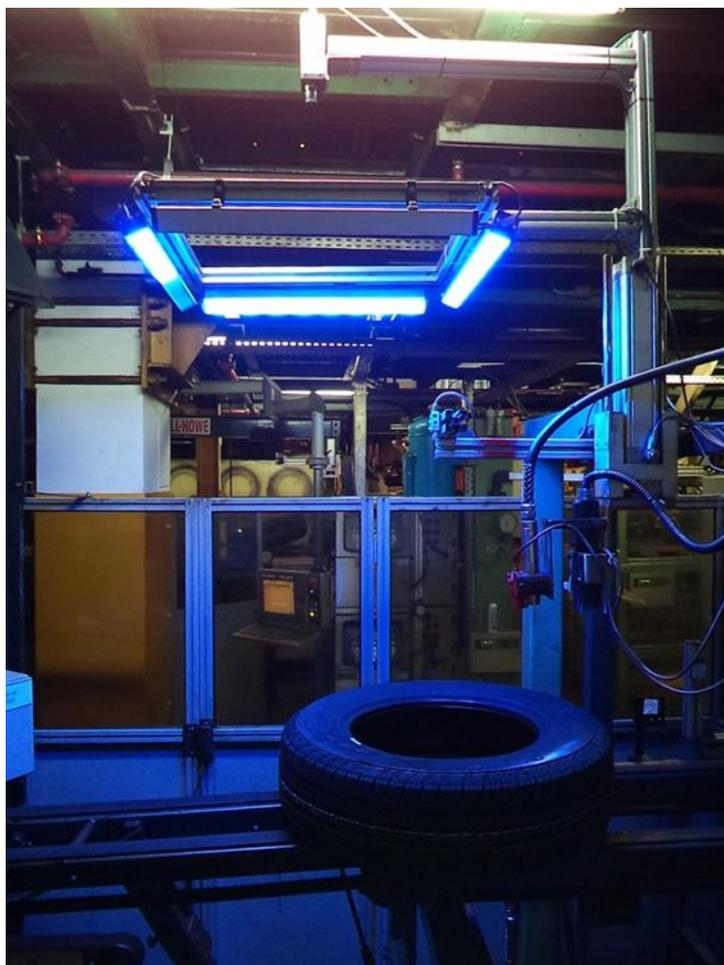
**Figura 4.15 – Sistema de câmara e iluminação colocados na MU#12.**
