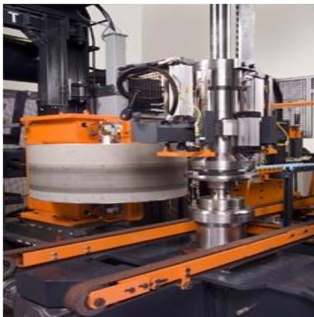
**Figura 4.1 – Tambor rotativo de uma máquina de uniformidade. (16)**
