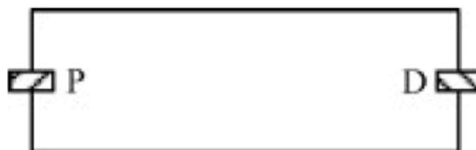
Figura 15 - Pontos de pick-up e drop-off de uma máquina com forma regular. Fonte: Drira, 2007
