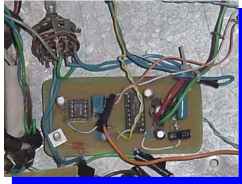
Foto 5. Circuito amplificador de potencia del tono
