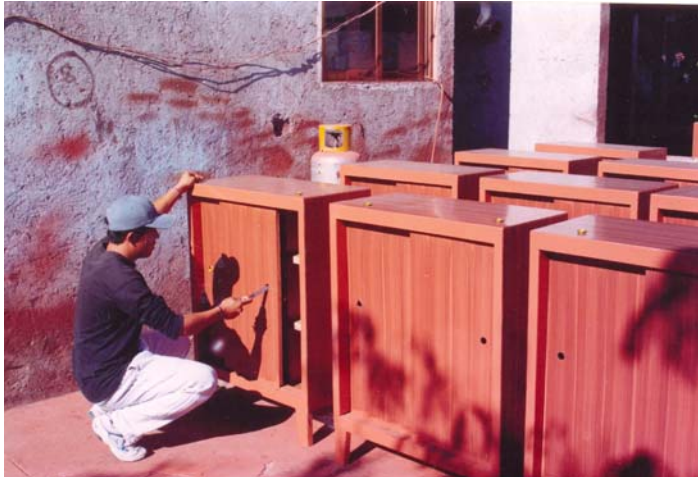
Figura 4.56 Colocación de herrajes
