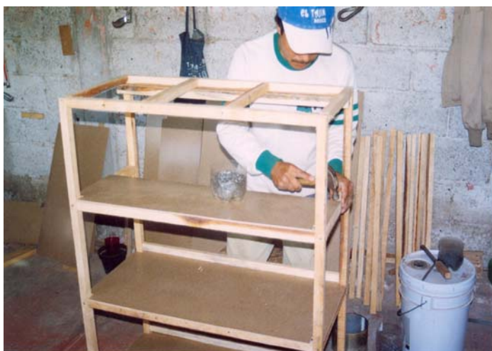
Figura 4.50 Ensamblar huacal con forros intermedios
