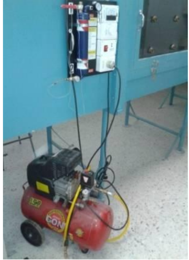
Figura 118. Sistema de Inyección de Humo
