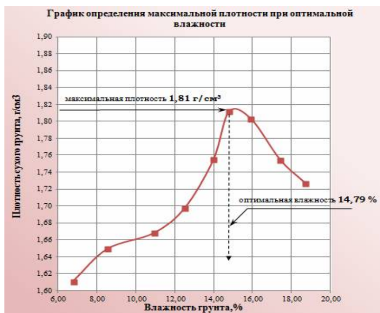
Рис. 2. Максимальная плотность при оптимальной влажности легкого суглинка
