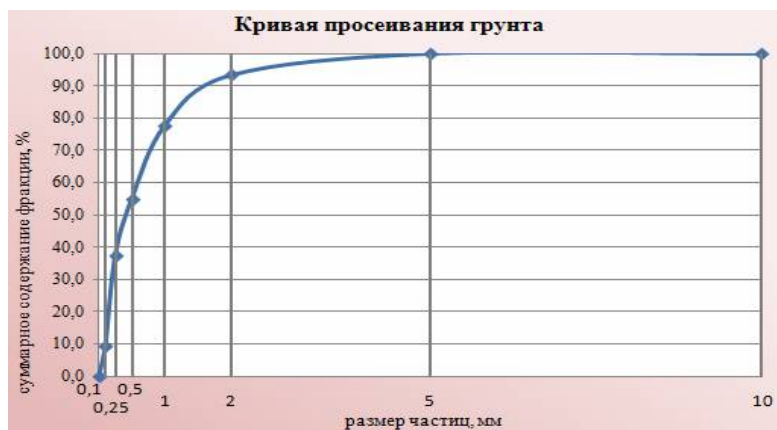
Рис. 1. Кривая просеивания грунта
