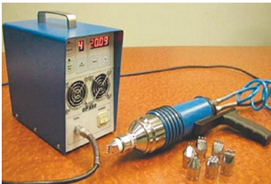
obr. 26: Zariadenie na dodatočné opracovanie zvaru metódou HFMI (33)
