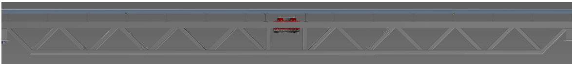
Obr. 37.: Pohled z boku na U profil a příhradovou konstrukci
