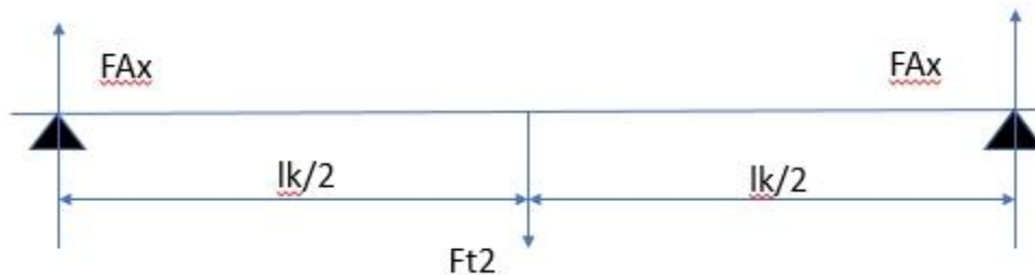
Obr. 25.: Schéma tečných sil v rovině šnekového kola
