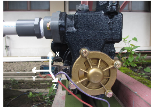
Gambar 3. Penempelan akselerometer pada pompa air. Diperlihatkan juga arah getaran pada sumbu X, Y, dan Z.
