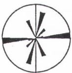
TRAVERSE PT I (Outcrop Fractures) N=43: 80-90-33%, 10-20-26%
