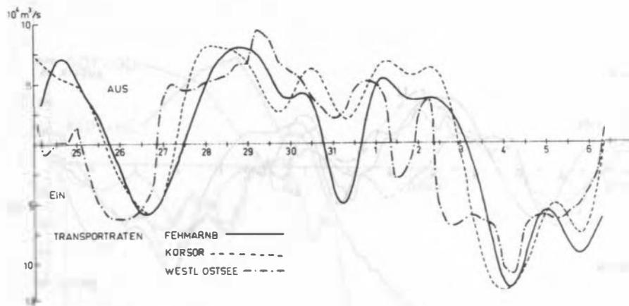
Abb. 12: Transportraten der Oberschicht im Fehmarnbelt (aus  $F.v'(11)$  berechnet), im Großen Belt bei Korsör (aus Oberflächenströmung berechnet) und zwischen Kap Arkona und Südschweden (aus Ost-Westkomponente des Windes über der westlichen Ostsee berechnet).
