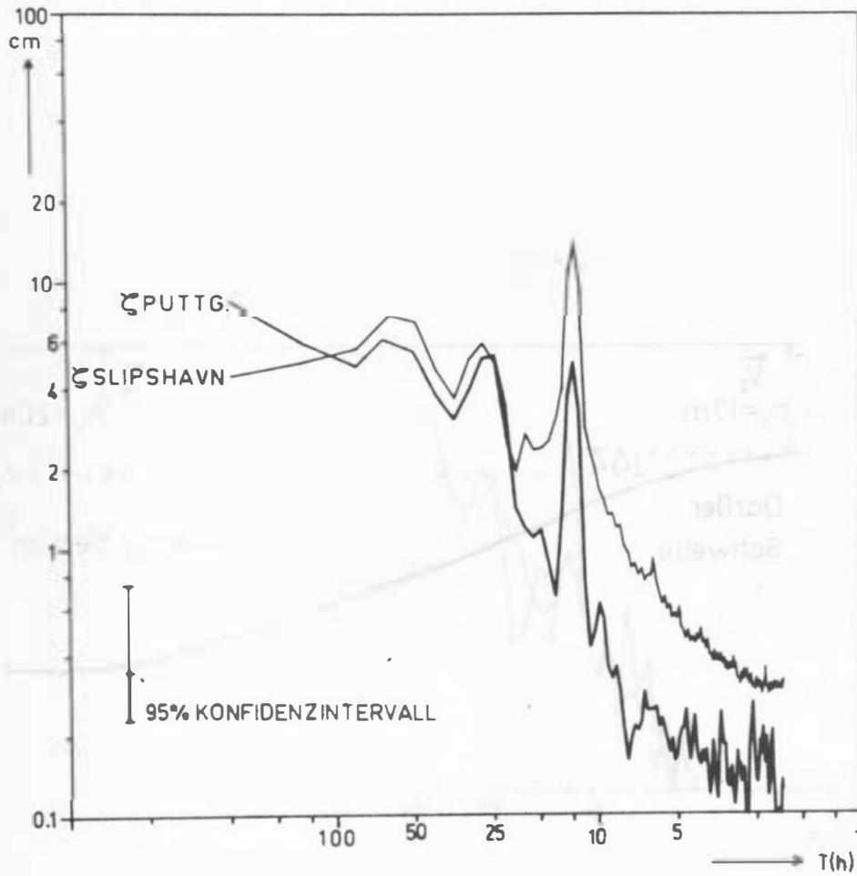
Abb. 18: Amplitudenspektren der Wasserstandsschwankungen in Puttgarden und Slipshavn.
