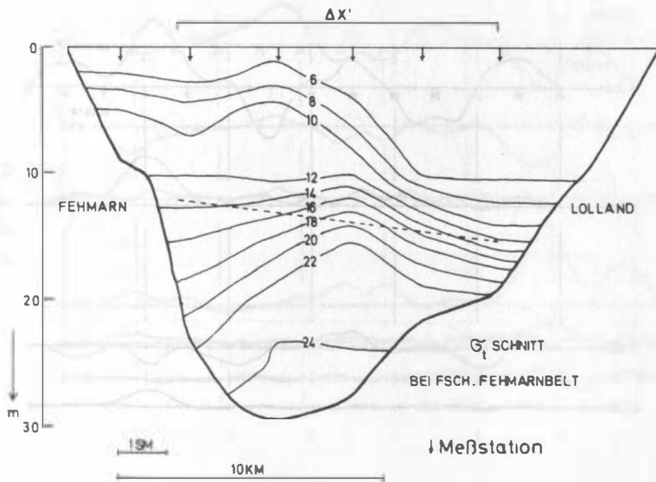
Abb. 7:  $\zeta_t$  Profil, aufgenommen am 24. 7. 72 zwischen 18.30 und 21.30 Uhr (die gerissene Linie zeigt die aus den mittleren Verhältnissen nach der Formel von Margules abgeschätzte Neigung einer idealen Grenzfläche zwischen Ober- und Unterschicht).
