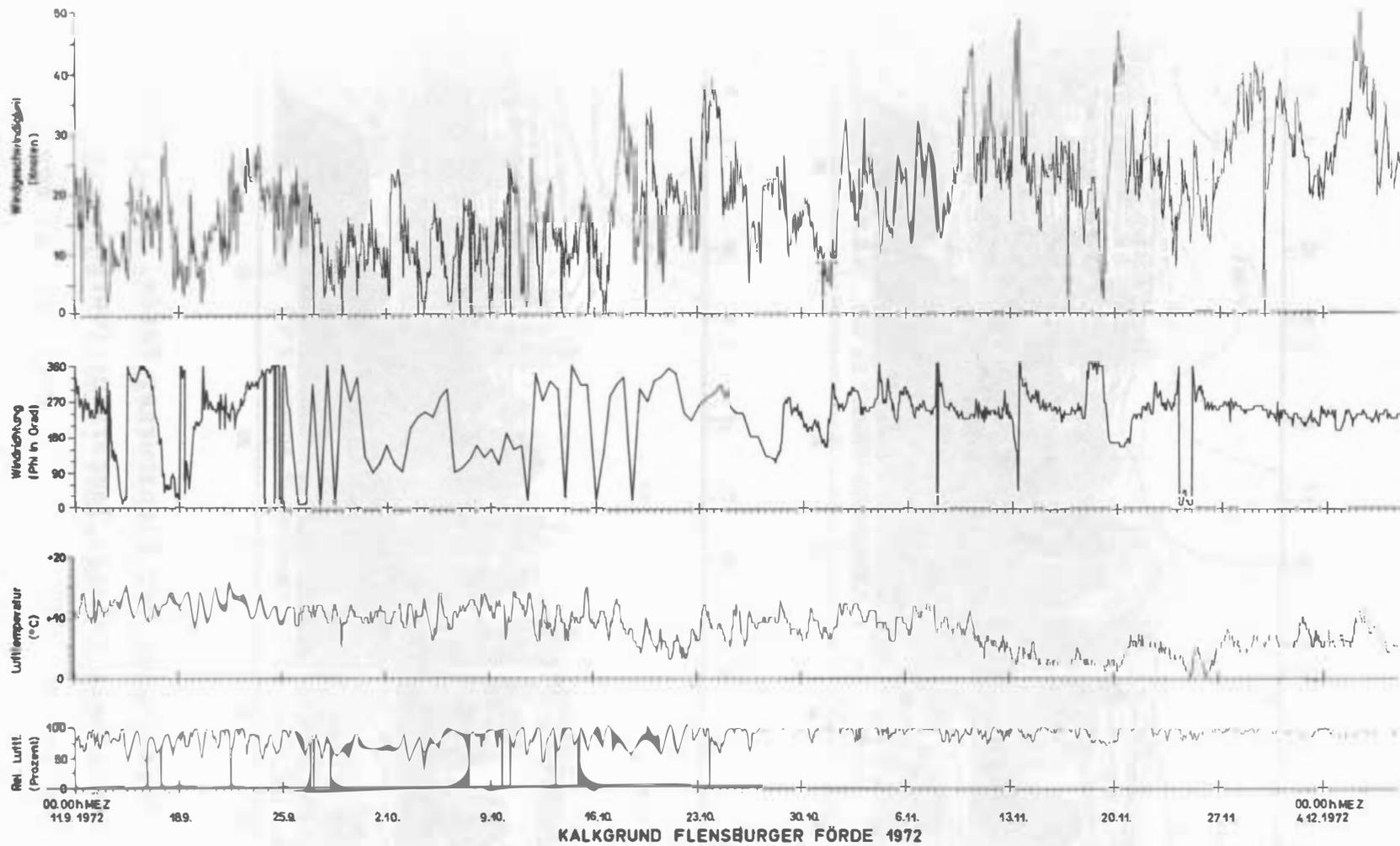
Abb. 26: Meteorologische Daten Leuchtturm Kalkgrund vom 11. 9. - 3. 12. 1972, Windrichtung vom 25. 9. - 28. 10. 72 12-stündig aufgetragen.
