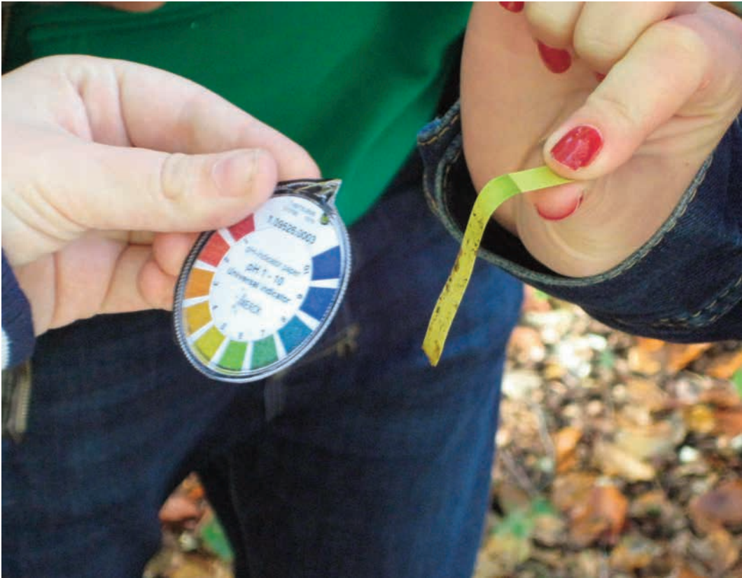
Abbildung 16: PH-Wert-Untersuchung des Bodens (Foto: E. Foos)
