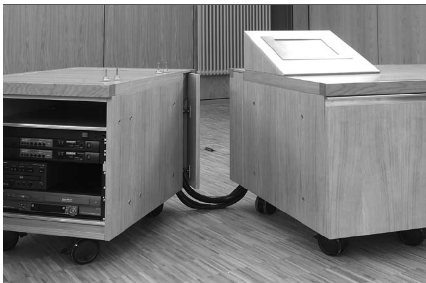
Abb. 8: Verbindung der Module des mobilen Pultsystems
