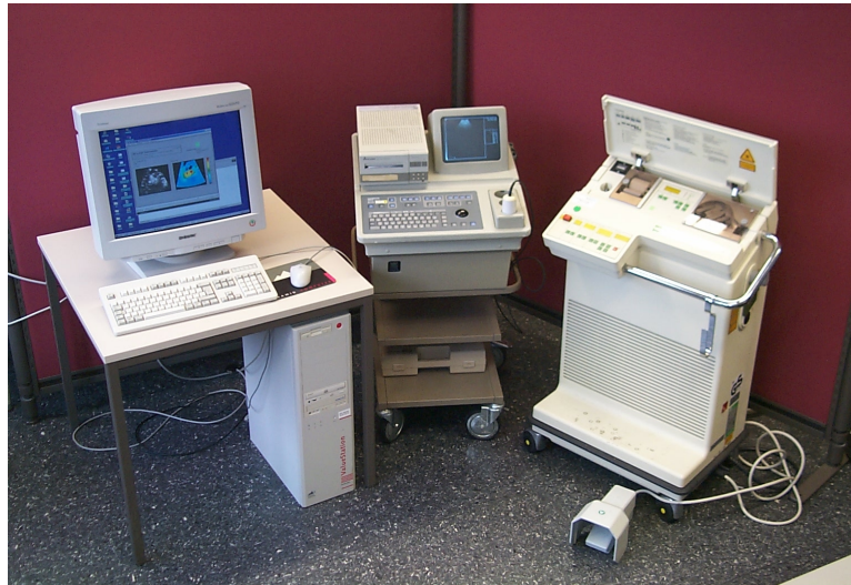
Abbildung 3.1: Experimentelles System bestehend aus Laser (rechts), Ultraschallgerät mit Zugriff auf die HF-Signale und Computer.
