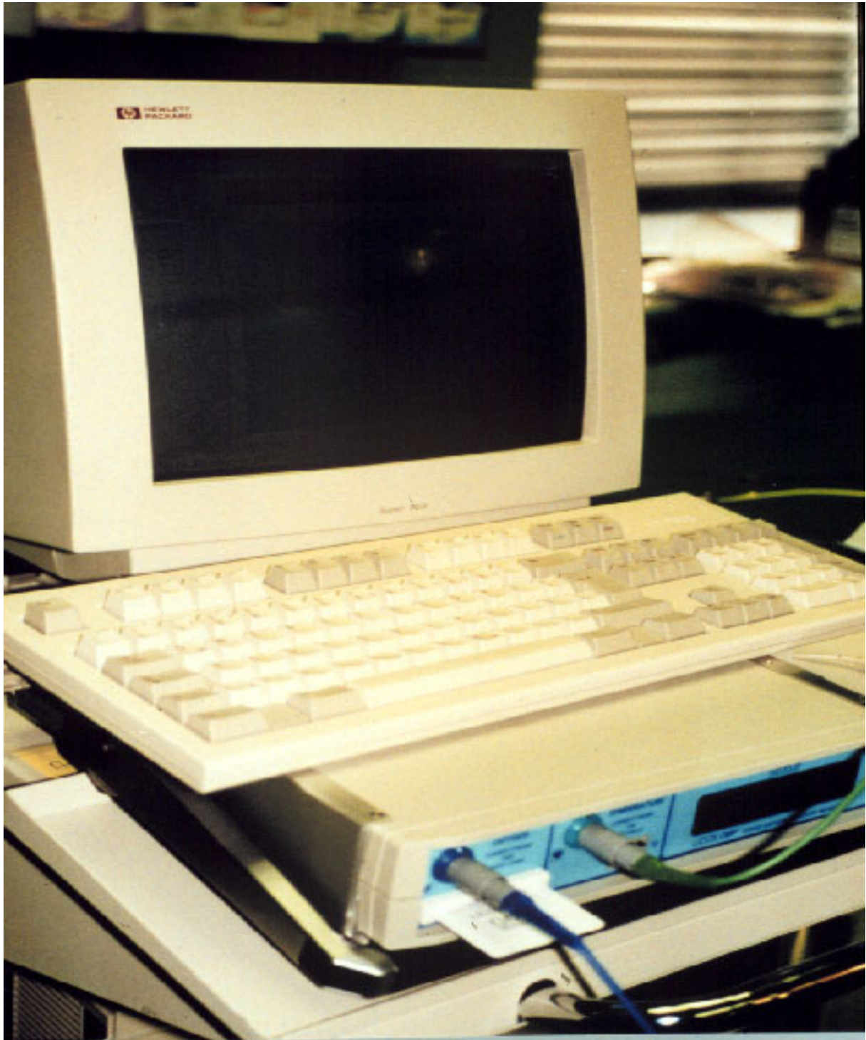
Abb. 32: Licox-System zur Messung des Sauerstoffpartialdruckes im Gewebe
