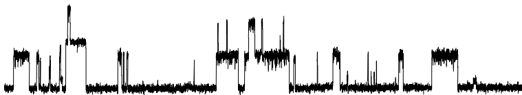
Abbildung 1.6 Einzelkanalaktivität von THF-gram und THF-gram-TBDPS (jeweils 10^{-8} M) durch Bilayermembranen in 1 molarer KCl-Lösung nach Anlegen einer Spannung von 100 mV (mit freundlicher Genehmigung von Prof. Koert, Universität Marburg).
