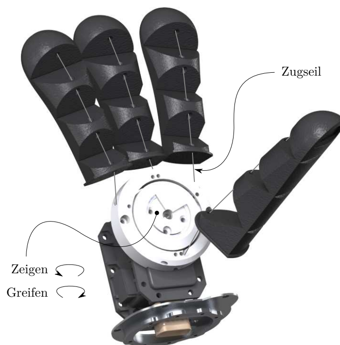
Abbildung 9.13.: Innerer Aufbau des Vierfingergreifers. Für die Ansicht des Servomotors und Seilzugsystems ist die Schale der Mittelhand ausgeblendet.
