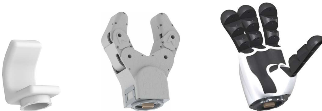
Abbildung 9.12.: Gerenderte Aufnahmen der drei Greifertypen, die bisher für den humanoiden Roboter Myon entwickelt und gefertigt wurden. Links: Sehr leichter nichtaktuierter Dummy-Greifer. Mitte: Viergelenkiger Zweipunktgreifer. Rechts: Vierfingergreifer.
