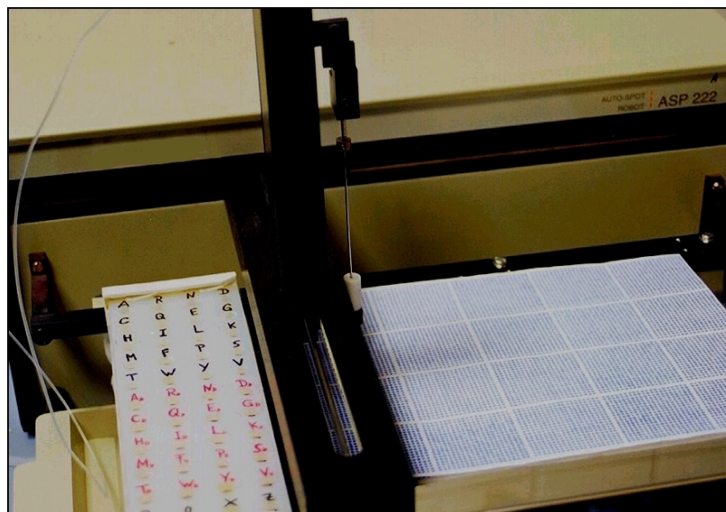
Abb. 3: Roboter zur automatischen Pipettierung von Reagenzien auf eine Zellulosemembran (SPOT-Synthese). Links befinden sich die Reagenzienvorräte, rechts ist eine 19 x 28 cm große Membran mit 8000 (blau eingefärbten) SPOTs fixiert.
