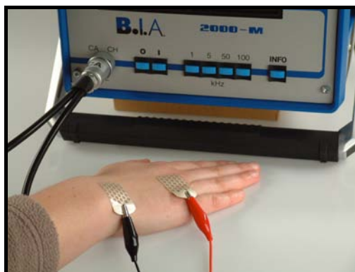
Abbildung 2: BIA-Messgerät und Elektrodenposition an der Hand
