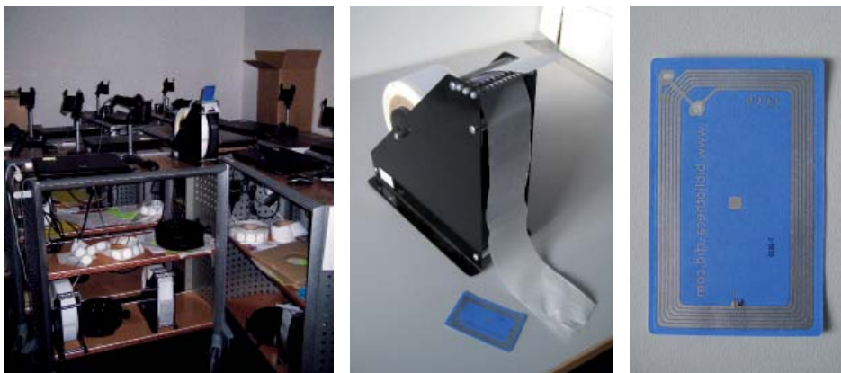
V.l.n.r.: Konvertierungsstationen. Abrollhilfe für RFID-Etiketten. Nahaufnahme RFID-Etikett.
