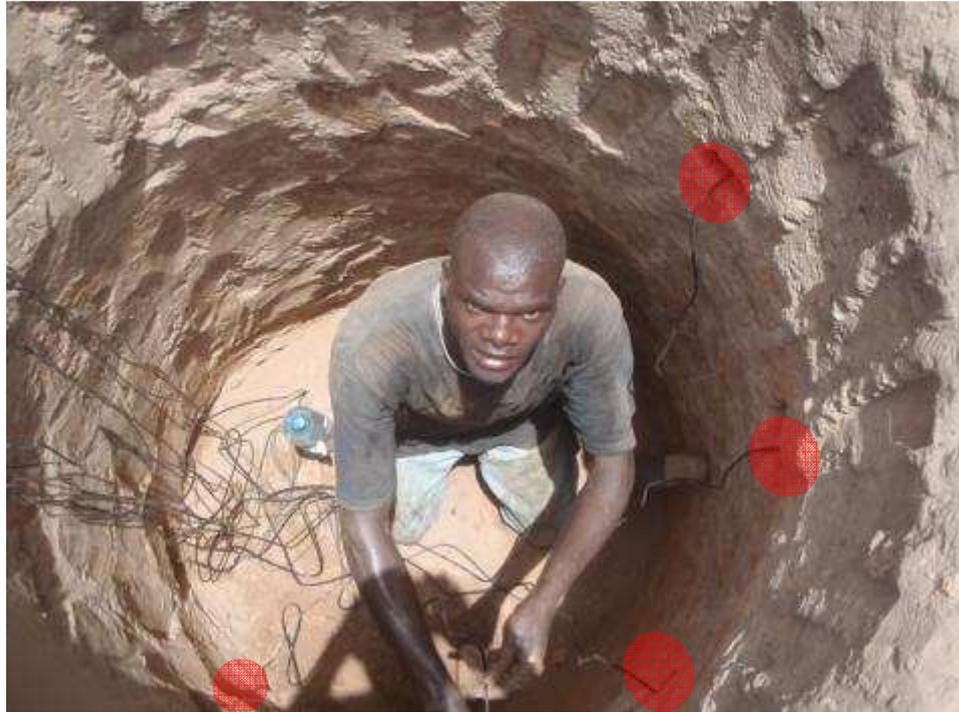
**Figure 17 Pose des sondes d'humidité du sol à la station 1160, 29 avril**
