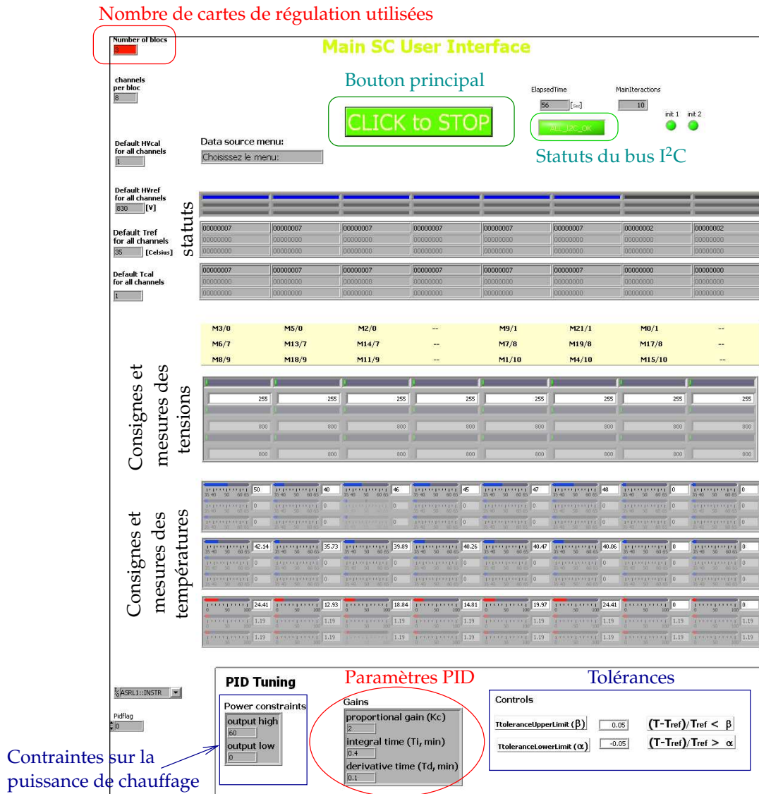
FIG. 2.8 – Interface utilisateur du programme SlowControl . Tout en haut figure un contrôle permettant de choisir le nombre de cartes de régulation qui seront utilisées (en rouge). Toujours au sommet, le gros bouton central permet de commencer ou d’arrêter la régulation. Suivent ensuite des indicateurs qui donnent les statuts des différents canaux. Au centre, figurent les valeurs de consignes et les mesures des tensions et des températures. Finalement, la dernière partie permet de paramétrer les valeurs des PID et des contraintes.
