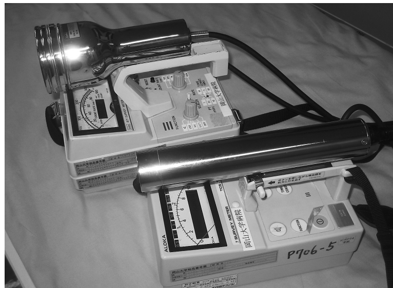
図1 放射線の測定に用いられる GM サーベイメータ (奥) とガンマ線用シンチレーションサーベイメータ (手前)
