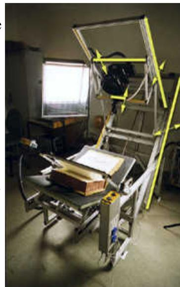
L'utilisation de ce scanner permet d'ouvrir un document selon un angle allant de 110° à 180°, 110° étant la limite en-deçà de laquelle la numérisation ne peut être effectuée.
