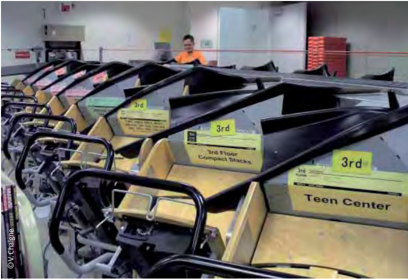
© V. Chaigne Système de tri automatisé des documents à San Francisco.
