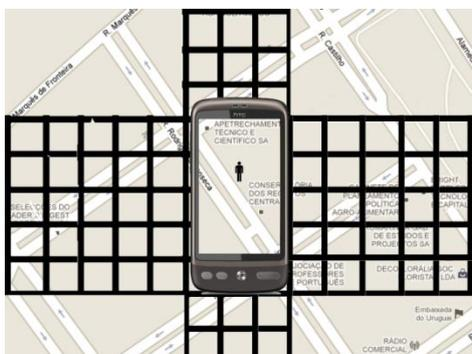
Figura 3.6 Representação da grelha com agregação dos cantos numa só célula para agregação de HaloDots.
