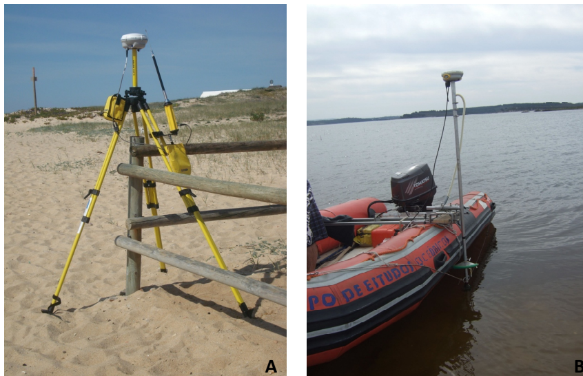
Figura 5: A – Estação base de DGPS RTK colocada no ponto de referência DET11 (Foto de C. Freitas); B – Estação móvel acoplada a uma eco-sonda na embarcação da Universidade do Algarve (Foto de R. Regala).
