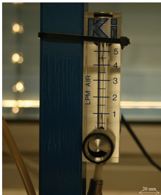
Figura 15: Fluxómetro de esfera para medida de fluxo de gás. A escala representa unidades de l/min.
