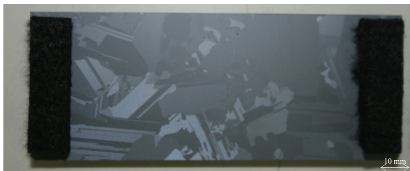
Figura 21: Disposição dos eletrodos de grafite sobre uma amostra de silício, antes da respetiva montagem no porta-amostras.
