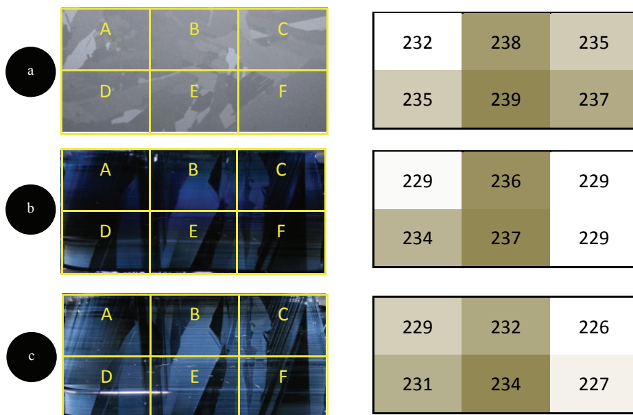
Figura 45: Imagem da superfície da mesma amostra a) antes da cristalização, b) depois da cristalização e com óxido e c) depois da cristalização e sem óxido. A segunda coluna corresponde ao respetivo mapeamento da espessura de cada amostra.
