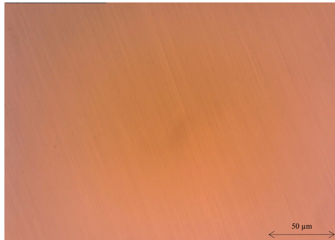
Figura 29: Fotografia de superfície após o processo de polimento mecânico.
