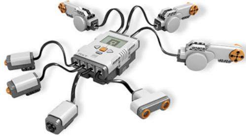
**Figura 1.1:** A figura mostra um *brick* ligado a três servo-motores e quatro sensores.
