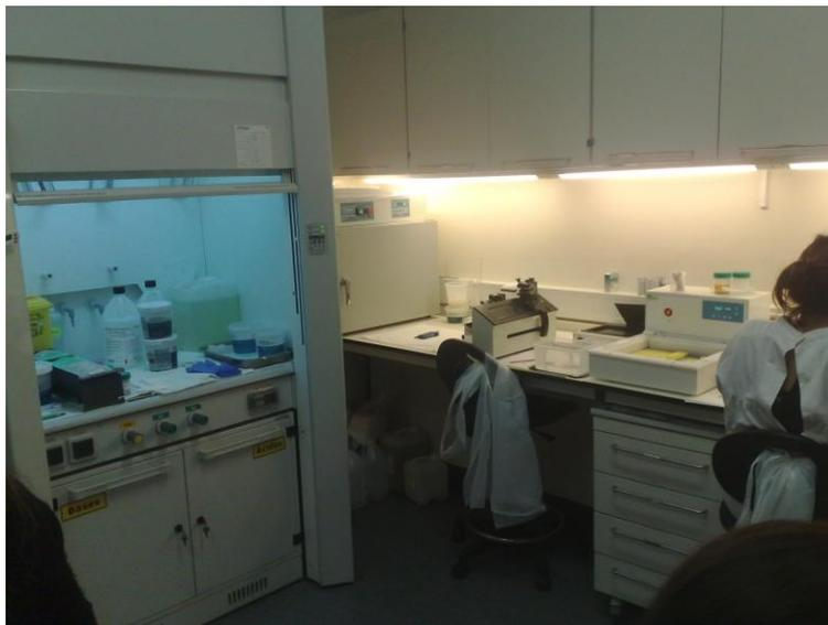
**Figura 31.** Pormenor de um laboratório de Anatomia Patológica com uma hotte, estufa de esterilização, micrótopo de correção e placa fria.
