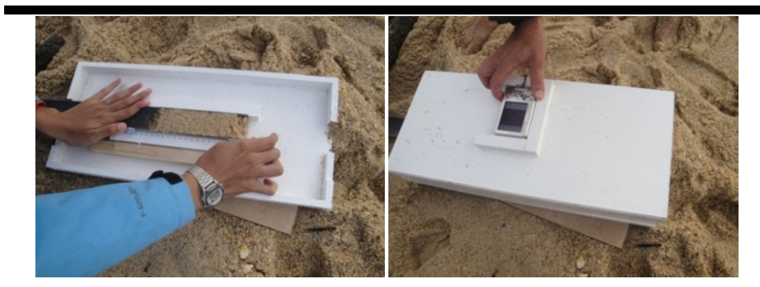
Figura 22. Aquisição das imagens verticais da camada de mistura a partir dos cores amostrados
