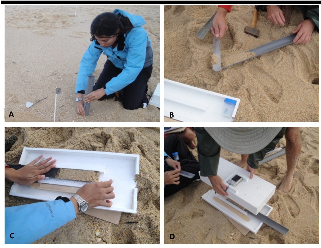
Figura 6. Metodologia de aquisição de imagens verticais. Amostragem do core (A). Core amostrado (B). Posicionamento do core (C). Aquisição da imagem (D).
