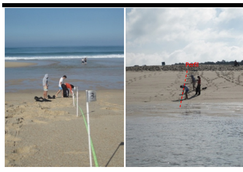
Figura 20. Posicionamento das estacas ao longo de um perfil perpendicular à costa na praia da Lagoa de Albufeira.
