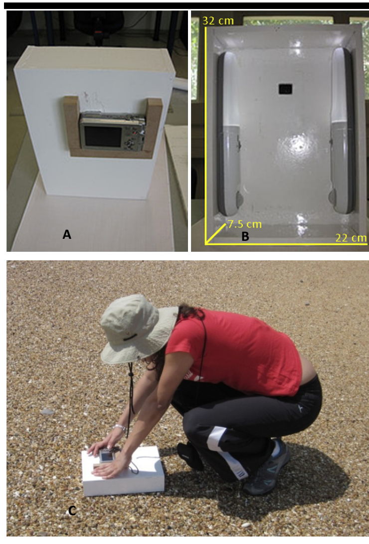
Figura 5. SAND BOX® vs. 1 (A e B). Aquisição de uma imagem superficial (C).
