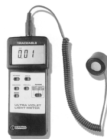
Luxímetro que monitoriza a iluminância e as radiações UV 559
