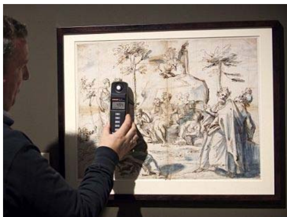
Luxímetro a medir a iluminância incidente num desenho em exposição 558
