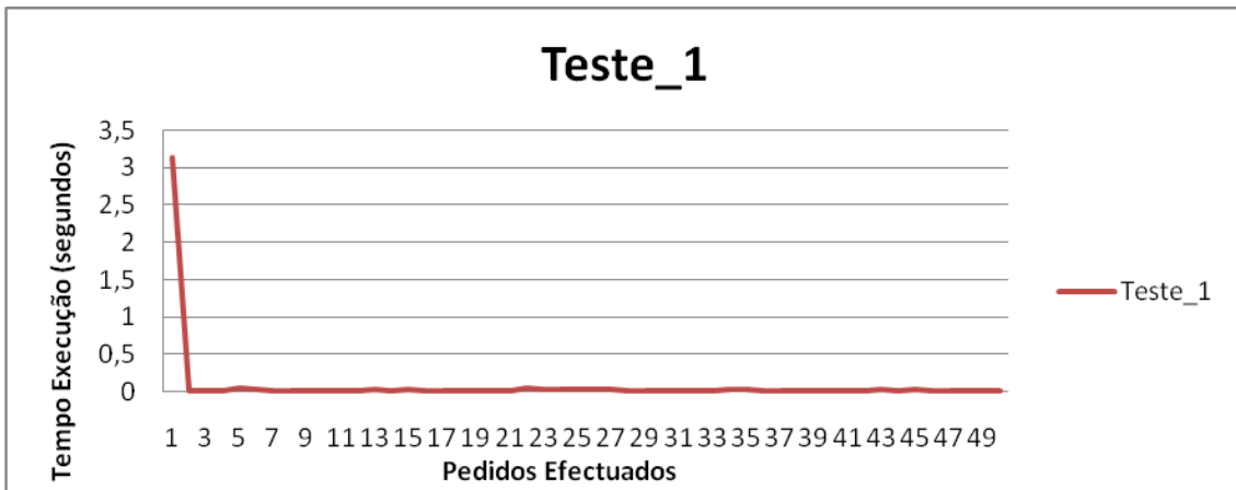
Figura 14: Tempos de resposta de um web service sem interposição do Service Broker. Teste efectuado com 50 pedidos.
