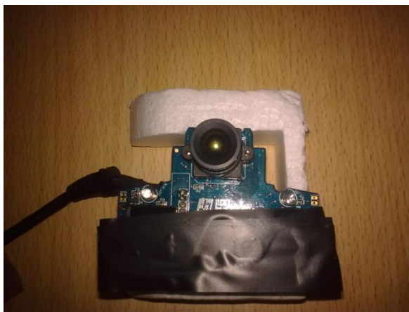
Figura 25: Sony Playstation 3 Eye alterada.
