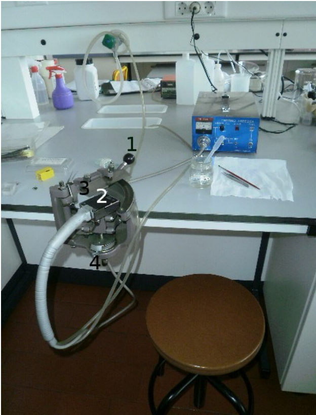
Figura 11: Micrótopo de congelação. Legenda: 1 - braço; 2 - suporte de congelação; 3 - lâmina; 4 - manivela de ajuste. Laboratório de Ecologia, Departamento de Biologia Vegetal, FCUL.
