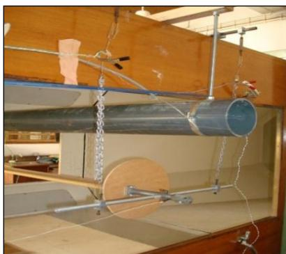
Figura 5.17 - Representação do diâmetro médio da torre e da distância entre a pá e a torre
