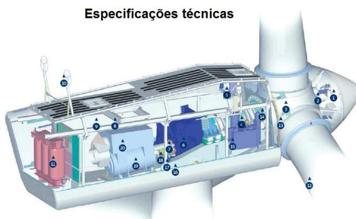
Figura 2.18 - Principais componentes [Adaptado: Catálogo Vestas V-80]
