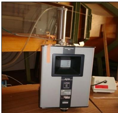
Figura 5.8 - Micromanómetro de Betz.
