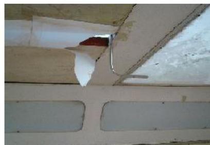
Figura 5.6 - Tubo de Pitot no interior do túnel de vento
