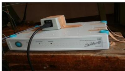
Figura 5.12 - Sistema de aquisição de dados Spider 8
