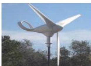
Figura 2.10 - Turbina eólica Turban<sup>3</sup>
