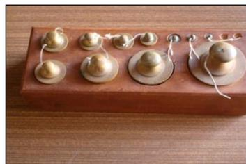
Figura 5.19 - Massas utilizadas para a calibração.
