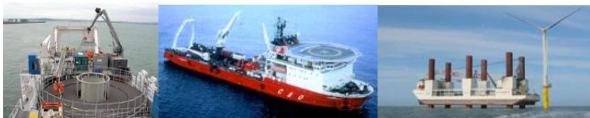
Figura 78, 79 e 80 - Exemplo de navios de colocação de cabos eléctricos<sup>58</sup>, de instalação<sup>59</sup> e especializado em instalação de turbinas eólicas<sup>59</sup>
