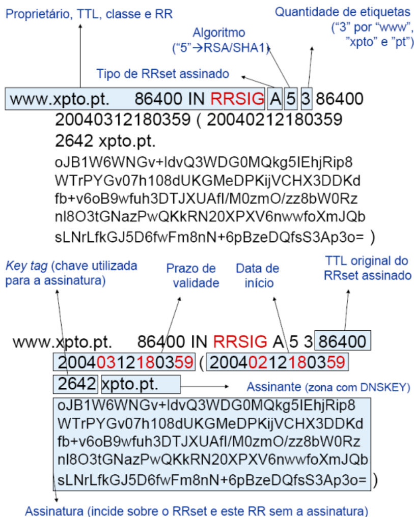
Figura 3.5: Exemplo de um RRSIG resource record
