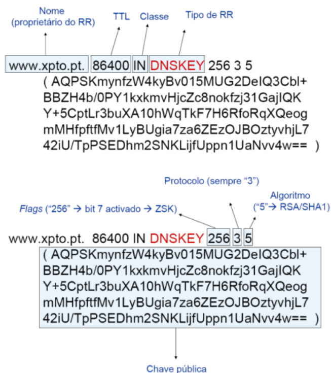
Figura 3.4: Exemplo de um DNSKEY resource record
